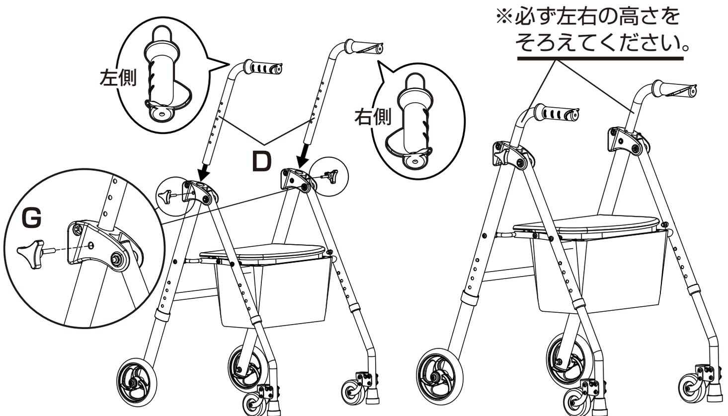
**5** 図の箇所に E. 背ベルトを取り付け F. 固定ピンで固定する。
