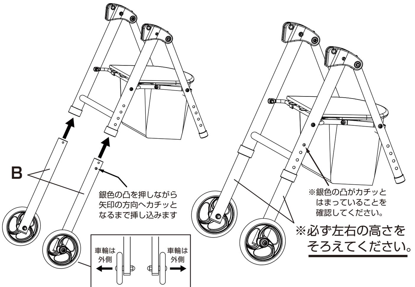
**3** **2** の反対側の脚に C. 後車輪 を図のように取りつける。
