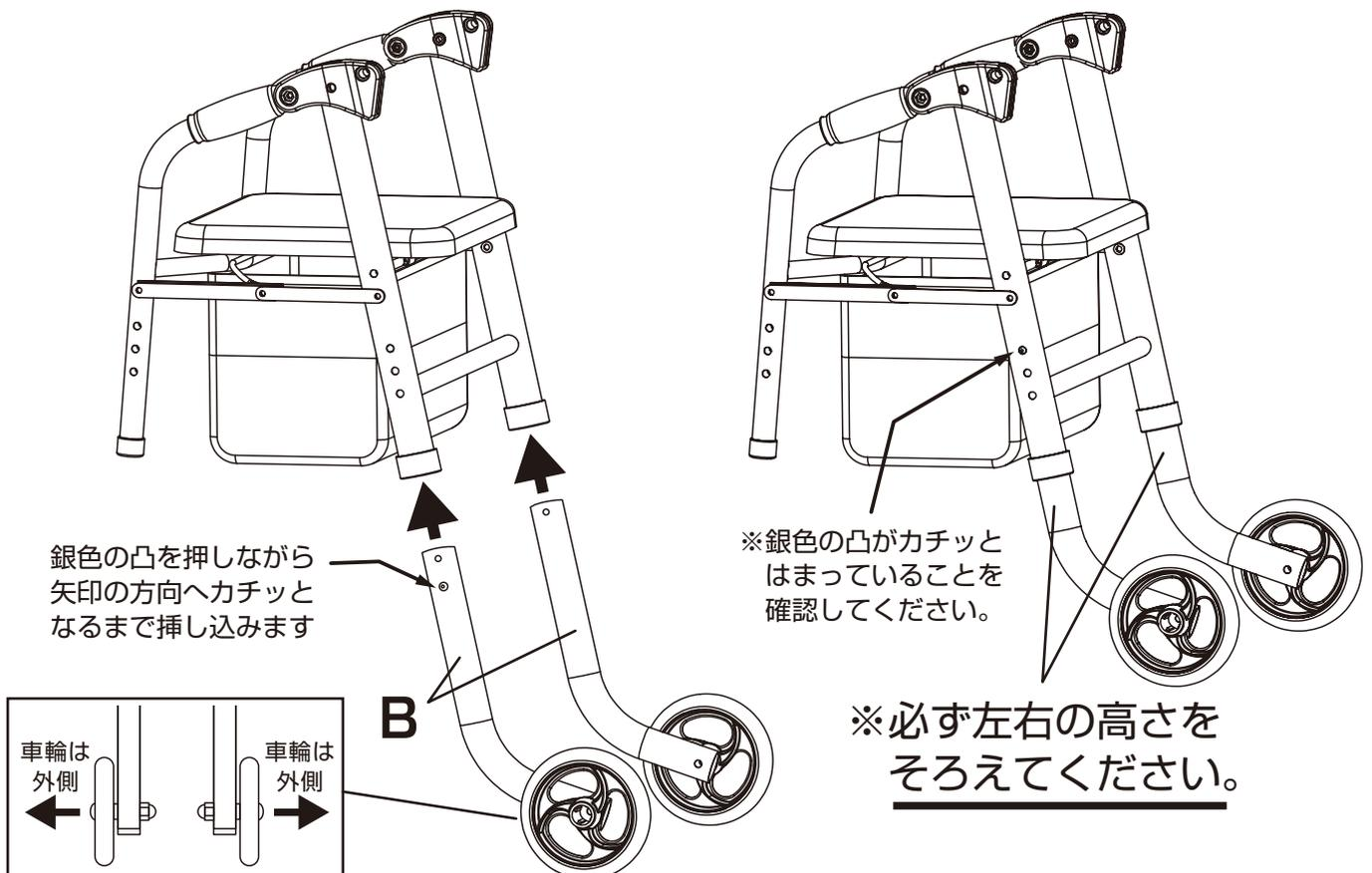
**3** **2**の反対側の脚に C. 後車輪 を図のように取りつける。
